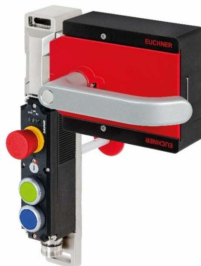
Les trous de fixation dans le module de poignée et la plaque support sont cachés, ceci offre une excellente protection contre les risques de manipulations. Le module de poignée comprend aussi un dispositif de consignation. Cela évite tout démarrage du système, par exemple pendant des travaux de maintenance et de nettoyage. Le raccordement simple par connecteur réduit le temps de câblage.
