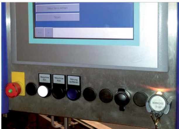
A la derecha de la unidad de manejo: el módulo adaptador para la llave del EKS Light
