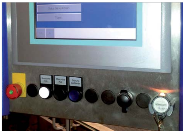
À droite de l'unité de commande : la serrure modulaire EKS Light
