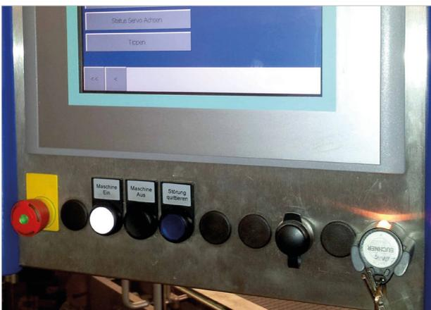
Rechts an der Bedienungseinheit: die modulare Schlüsselaufnahme von EKS Light.
