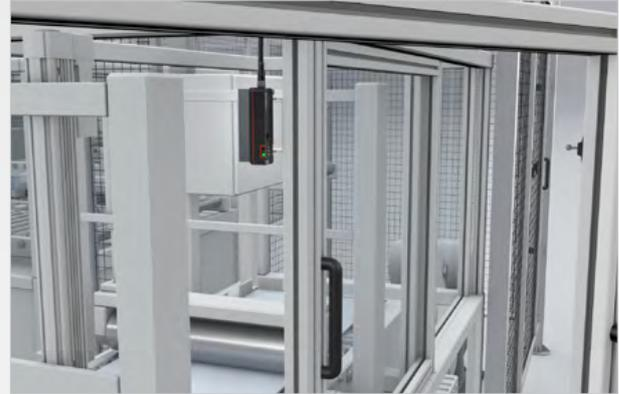
► Con **función de bloqueo biestable**: el CTM evita que las personas se queden encerradas accidentalmente en caso de producirse un corte de corriente.
