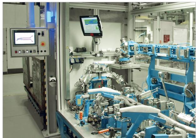
Abb. 1: Nur besonders ausgebildetes Personal darf an der Prüfanlage für den Abgasstrang sensible Einricht- und Wartungsarbeiten ausführen – dies stellt das elektronische Schlüsselssystem EKS sicher
