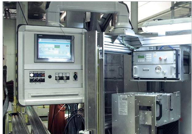
Abb. 2: Der Schlüssel steckt in der Schlüsselaufnahme des EKS *Light* (r.)
